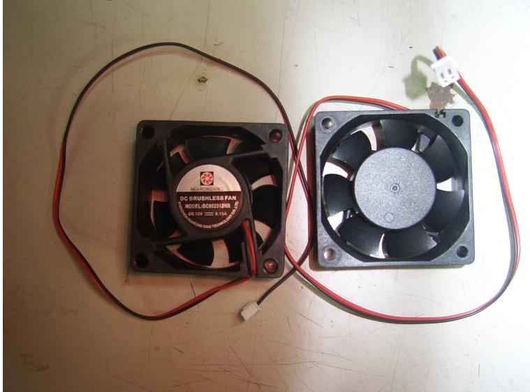
Ventilateur 60x60x25mm 12Vdc 0.13A 1.6W pour lyre Beam5R Starway
