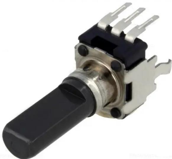
Potentiomètre simple B10K linéaire axial monotour arbre méplat D 6mm
