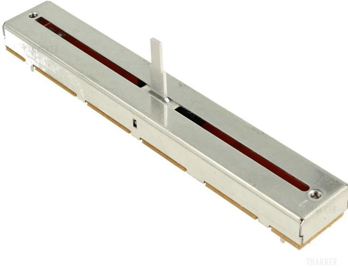
Fader pitch pour platine vinyle Technics SL1200 1210 MK2
