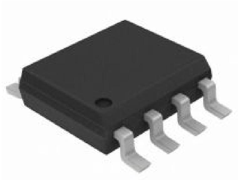
Régulateur LM317LBDG stabilisateur de tension linéaire réglable 1.2 à 37V 0.1A SO-8
