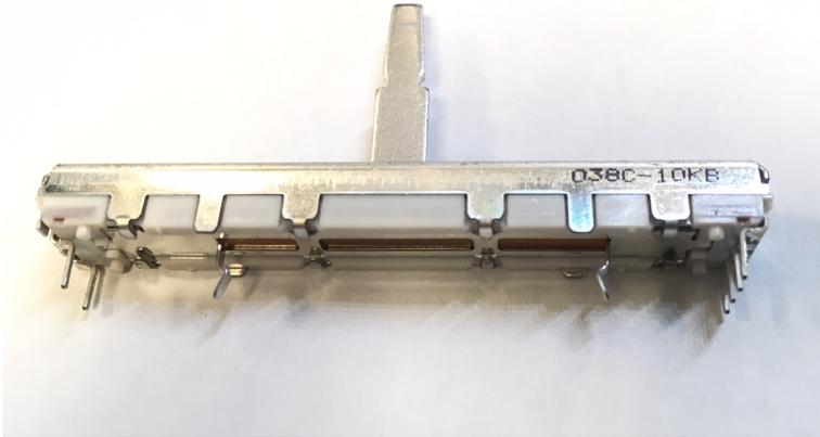
Fader DCV1035 de canal CH1-4 pour contrôleur Pioneer DDJ
