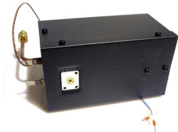
Corps de chauffe pour machine à brouillard Antari Z350
