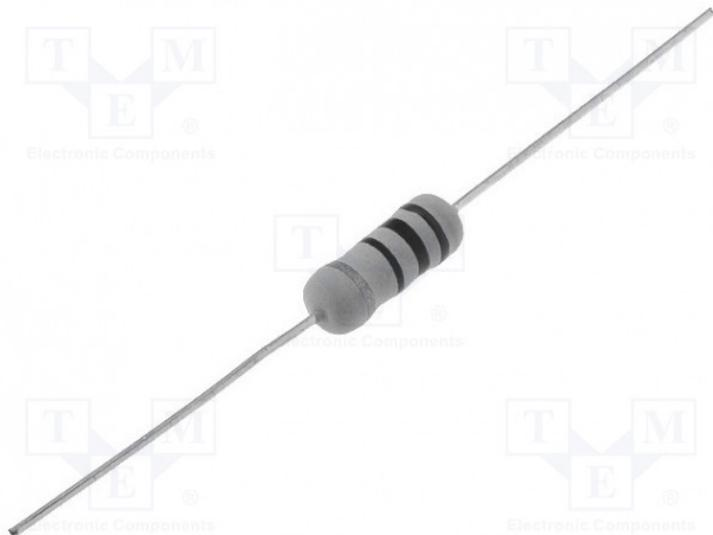
Résistance 10R 2W ±5% bobinée THT 5x12mm 400ppm/°C
