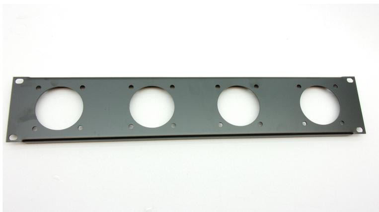
face avant de rack 2U avec perçage pour 4 embases P17 16A ou 32A entraxe 56mm
