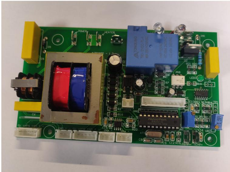
Carte commande et puissance pour machine à fumée ibiza lsm 1200 pro
