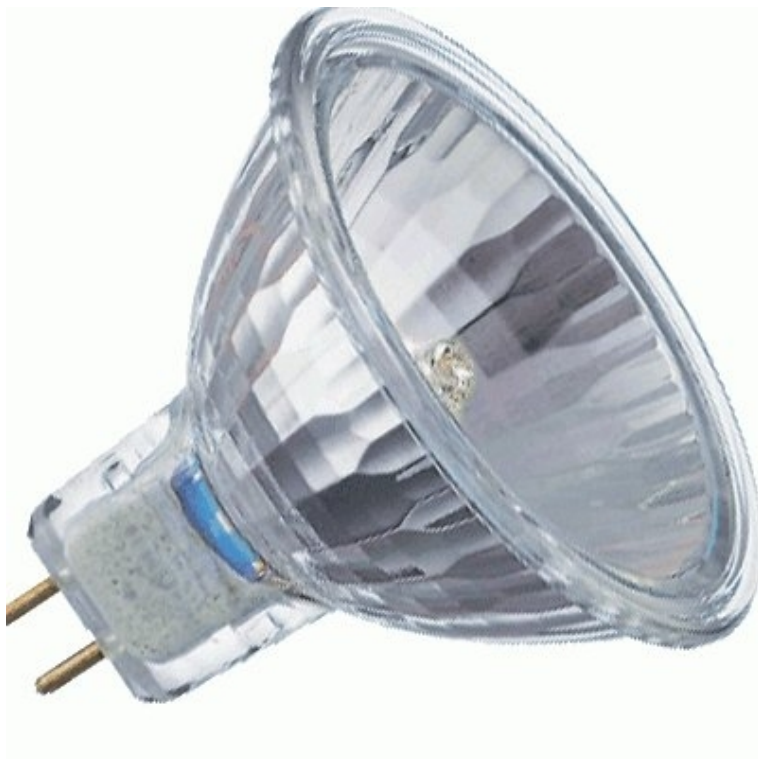
LAMPE Philips Masterline ES 12V 30W GU5.3 36°
