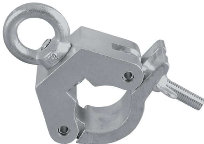
Crochet clamp 800 kg pour tube 50mm eurolite TPC-51 avec anneau de levage
