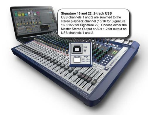
Les consoles Signature 16 et 22 ont une fonctionnalité d'entrée et de sortie USB à 2 pistes. Cela peut être utilisé pour enregistrer un mix sur un PC ou une tablette, par exemple - ou pour utiliser un ordinateur comme appareil de lecture. Les canaux 1 et 2 sont reçus par le canal de lecture stéréo (15/16 pour Signature 16, 21/22 pour Signature 22).
