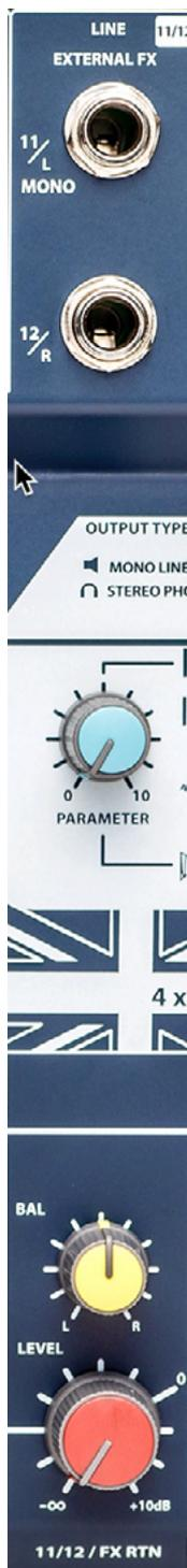
L'envoi Aux / FX est pré-fade en raison de la double utilisation du bus Aux. La contribution d'un canal d'entrée à ce champ de traitement Aux Send est indépendante de la contribution de niveau de ce canal au mixage stéréo principal.
