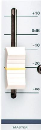
Le canal Master Stereo Output détermine le niveau de sortie du mixage du bus stéréo principal (gauche et droit) à partir des sorties physiques Master L et Master R.
