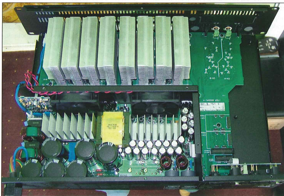
Po odkręceniu obudów widać radiatory z tranzystorami mocy, których ilość zależy od mocy wzmacniacza – SP2K4 dysponuje 6 tranzystorami na stronę (4 radiatory), natomiast SP4K ma ich 12 (8 radiatorów).
