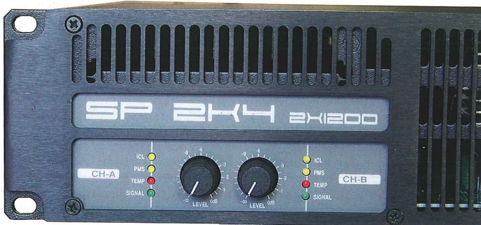
Na płycie czołowej obu wzmacniaczy znajdują się: wyłącznik zasilania, potencjometry poziomu sygnału kanału lewego i prawego oraz diody LED sygnalizujące stan pracy urządzenia.
