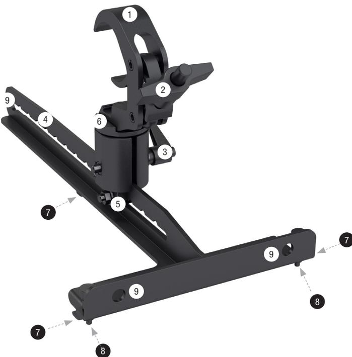
9 Führen Sie alle drei Stahlhaken des EasyMount Haltebügels in die entsprechenden Haltebuchsen des Lautsprechers ein.
